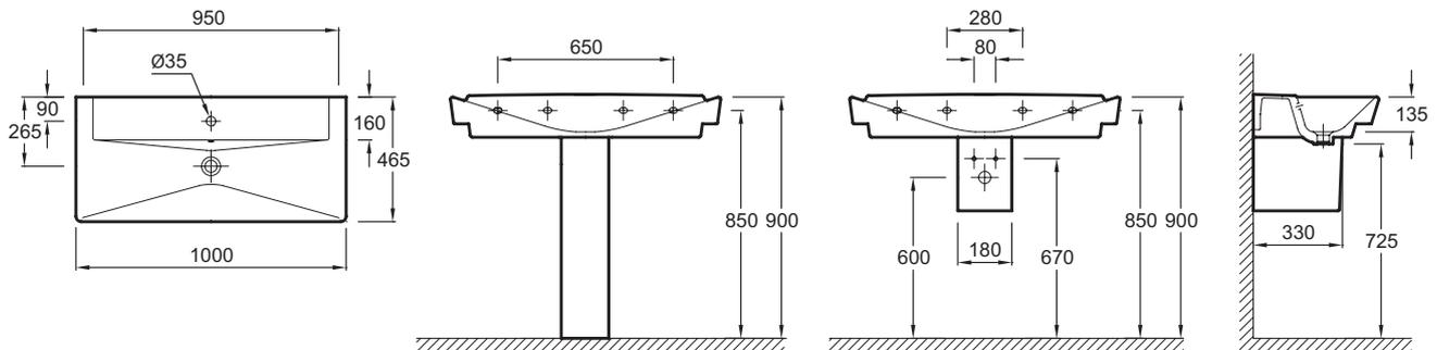
Спецификация продукта: Подвесная раковина-столешница 100 x 46.5 см. E4801. Коллекция: REVE. Размеры (см): 100 x 46,5 см. Вес: 33,1 кг. Разметка сверления отверстия для смесителя: 1 отверстие для смесителя посередине.
